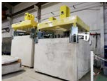
Equipo de manipulación de contenedores de 40Tn, para la IPM de Ondraf-Niras (Bélgica)
