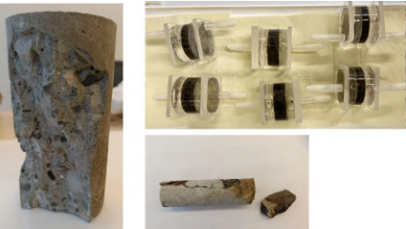
Muestras de hormigón y roca madre antes del tratamiento (izquierda y abajo) y acondicionadas para los ensayos de difusión a través del material (arriba derecha)
